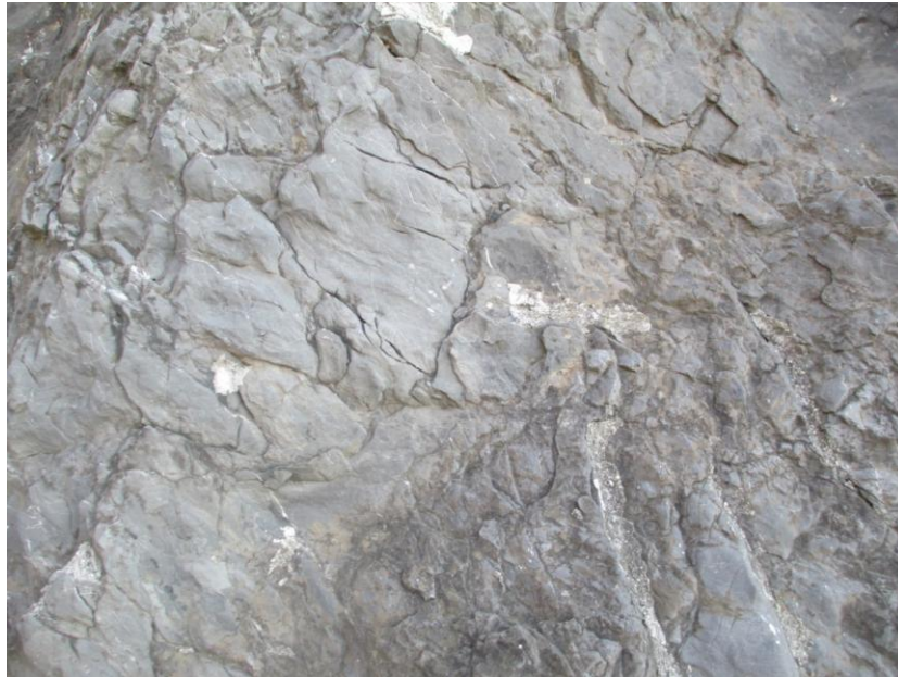
Figura 30: Dolomia Principale (si noti come la roccia appaia in buono stato nonostante la presenza di discontinuità)
