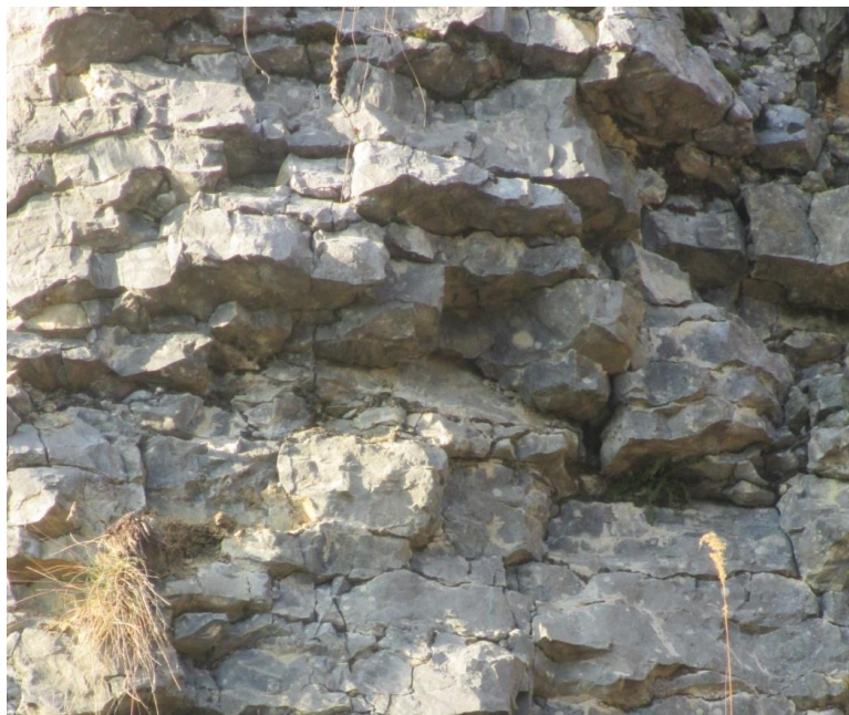
Figura 33: Famiglie di discontinuità presenti nel Calcarea di Zu
