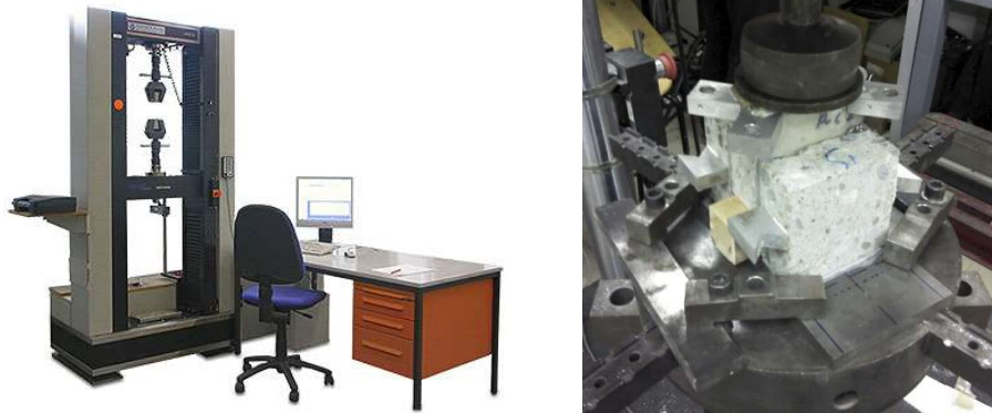
Figura 3.3. Strumentazione di prova, fissaggio provino nella macchina Instron.
