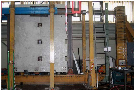
Figura 3.5 Impianto di prova su sottosistema strutturale assemblato.
