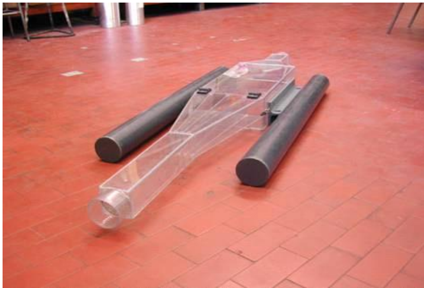
Figura 20: Wind Tunnel elaborata presso il laboratorio olfattometrico del Politecnico di Milano
