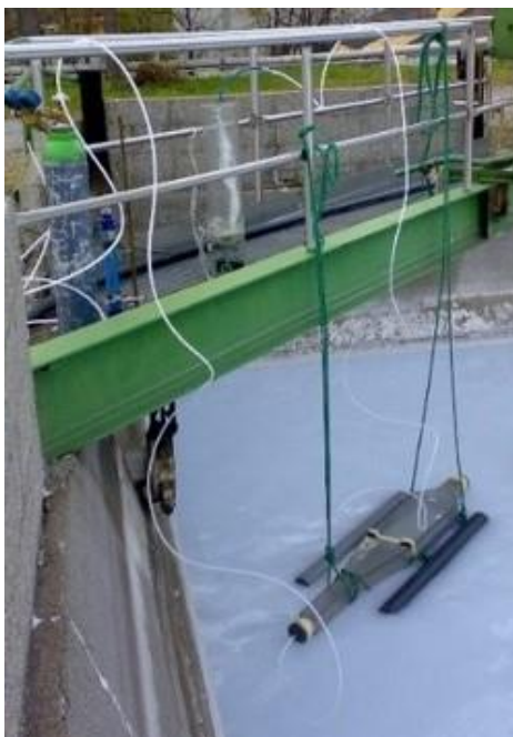
Figura 13: Wind Tunnel sviluppata dal laboratorio olfattometrico del Politecnico di Milano (Capelli et al., 2009)
