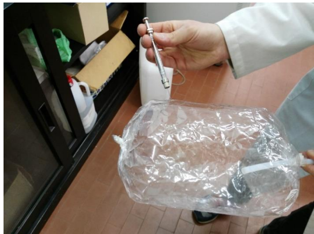
Figura 37: Prelievo del campione gassoso dal bag mediante siringa
