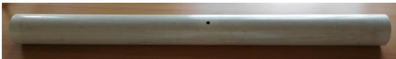
Figura 24: Tubo in polietilene con foro di prelievo
