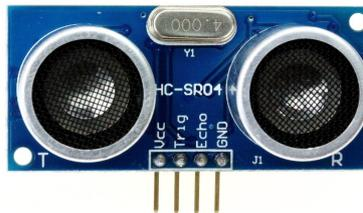
Figure 5.9: Vista frontale di un sensore sonar HC-SR04
