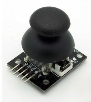
Figure 5.22: Modulo Joystick per Arduino, molto simile a quello del controller della famosa Playstation
