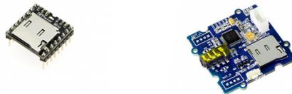
Figure 4.3: Esempi di riproduttori MP3: a sinistra un modulo DF Player e sulla destra un SerialMP3 Player
