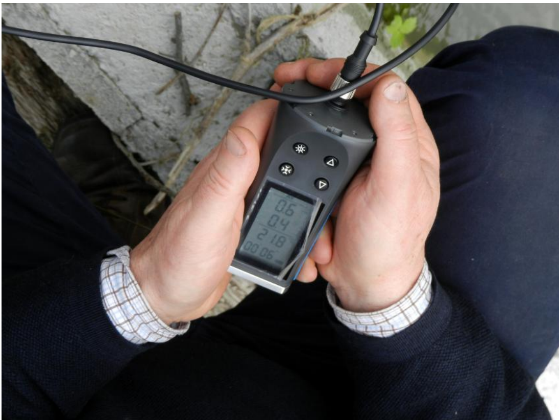
Figura 19: calcolo della velocità di corrente mediante anemometro
