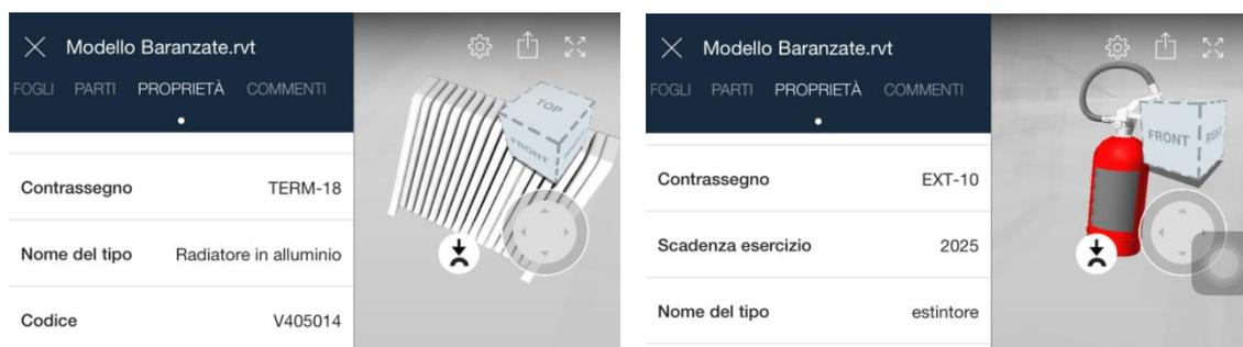
FIGURA 1.18 - A360: VISUALIZZAZIONE DATI COMPONENTI
