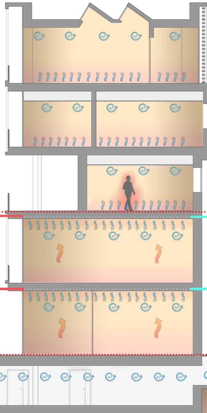
PORZIONE DI EDIFICIO CON FUNZIONAMENTO AD ATTIVAZIONE TERMICA DELLA MASSA
