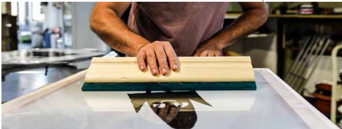
Figura 32 Deposizione dell'inchiostro durante la serigrafia
