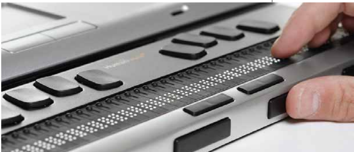
Figura 19 Terminale braille con celle piezoelettriche collegato al PC
