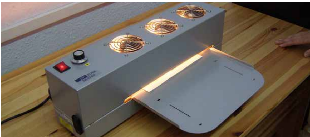
Figure 26 e 27 Dettaglio del rilievo ottenuto tramite carta a microcapsule riscaldata nel fornello a infrarossi (2) - Fornello a infrarossi ZYFuse
