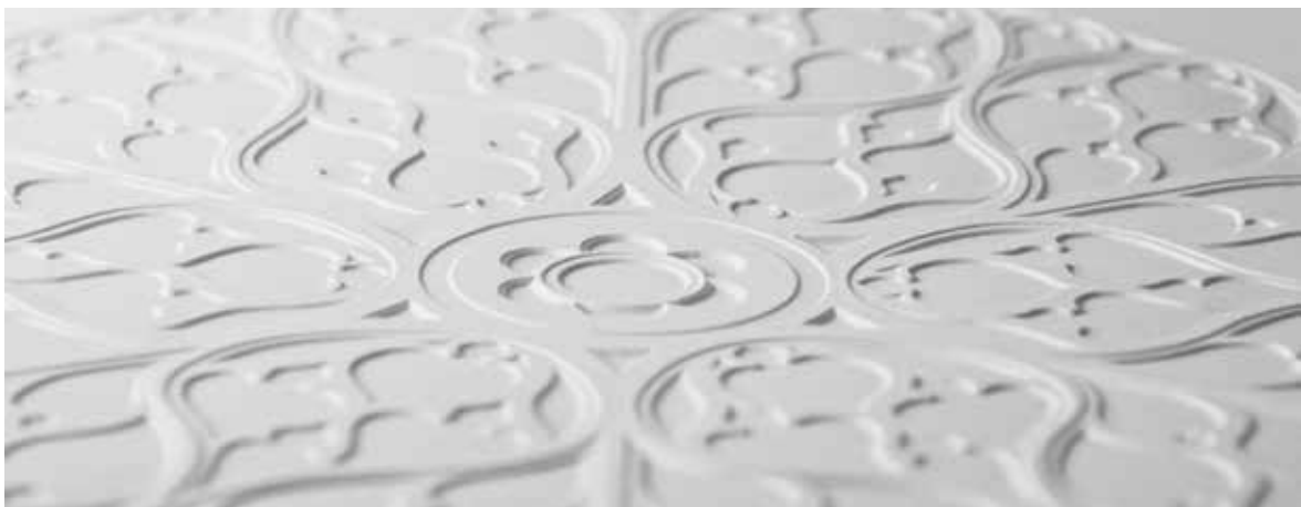
Figura 29 Dettaglio del rilievo ottenuto tramite la tecnica del Gaufrage (2)
