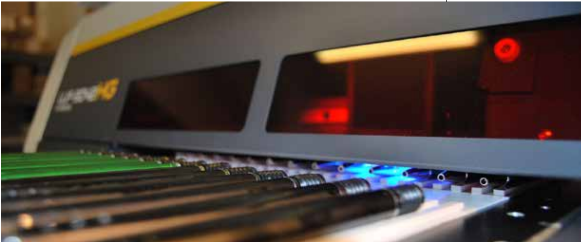
Figura 64 Stampante UV Mimaki in fase di stampa su alcuni prodotti finiti
