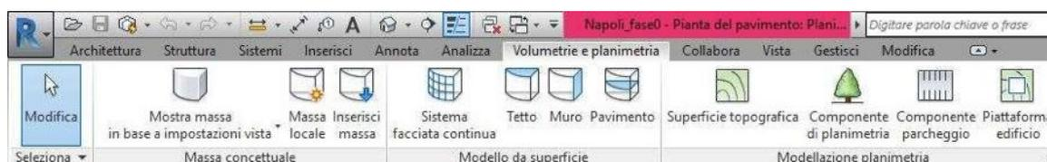
Figura 86 Visualizzazione della barra che consente la creazione di superfici topografiche in Revit.
