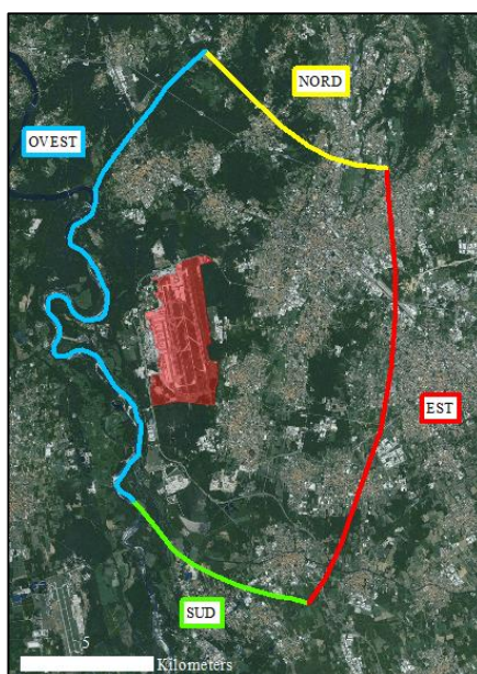
Figura 3-1: Area di definizione del modello numerico e relative condizioni al contorno
