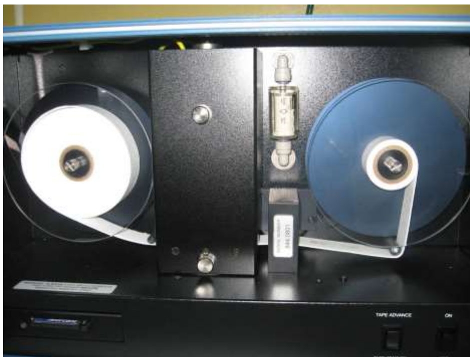
Figura 2.9 – Nastro interno allo strumento Etalometro
