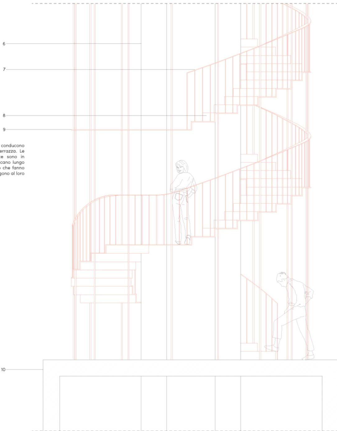
Le scale in acciaio verniciato conducono dal primo piano fino alla terrazza. Le scale al piano terra invece sono in cemento armato. Si arrampicano lungo le due C in cemento armato che fanno loro da sostegno e che accolgono al loro interno il vano ascensore.
