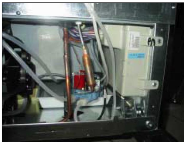
Figura 24: posizionamento dell'hardware del sistema di controllo
