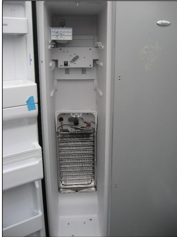
Figura 19: posizione dell'evaporatore all'interno dello scomparto freezer
