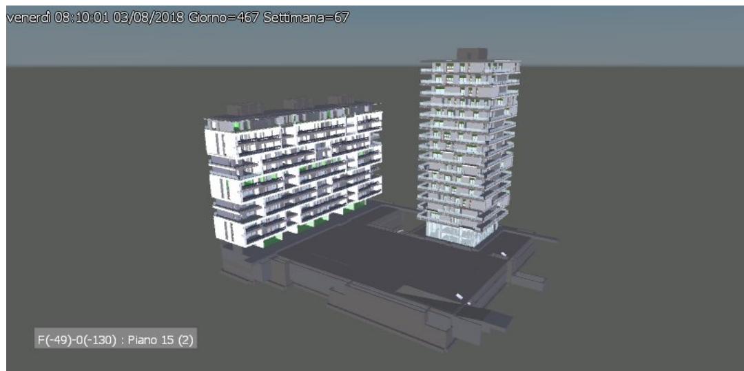
Figura 4.31 Simulazione 4D - Tower ultimata e Montaggio facciata continua e posa porte Garden
