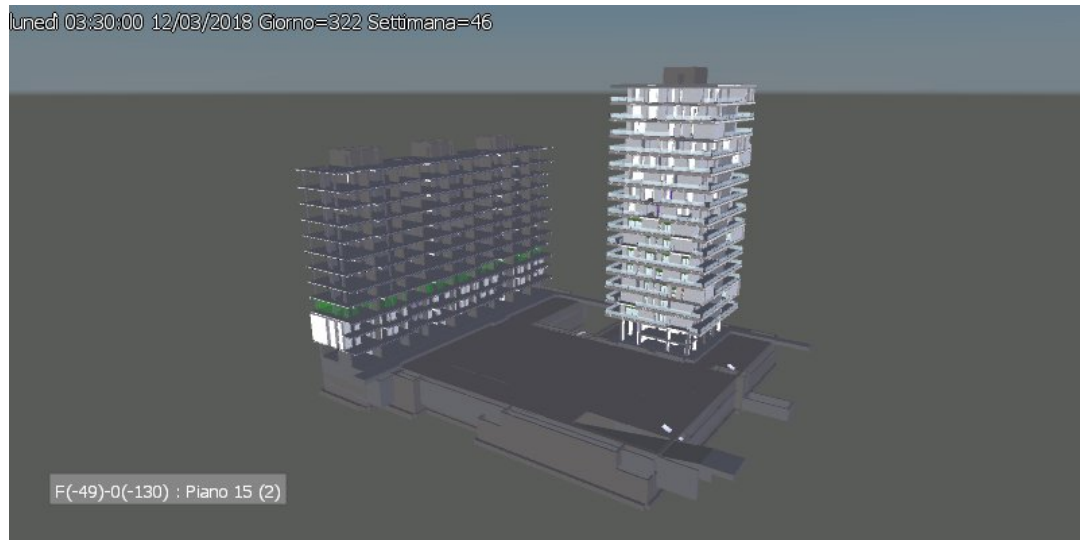
Figura 4.27 Simulazione 4D - Montaggio finestre Tower, Chiusure Garden e Posa basculanti Piastra
