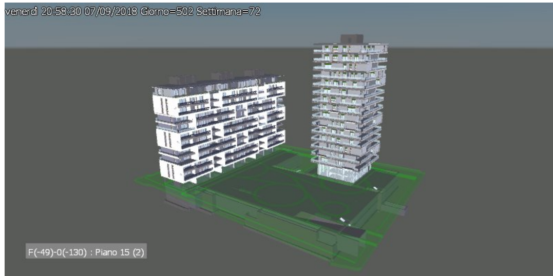
Figura 4.33 Simulazione 4D - Tower e Garden ultimati e Finiture piano terra Piastra
