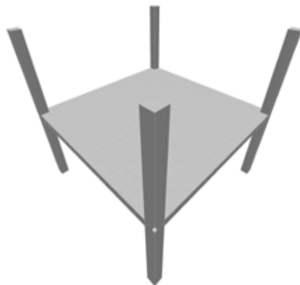
fig.9.59 MODELLI AD ELEMENTI FINITI. PIASTRA DI COPERTURA ANALISI QUALITATIVA PER LA DETERMINAZIONE DEL MODULO CRITICO.
