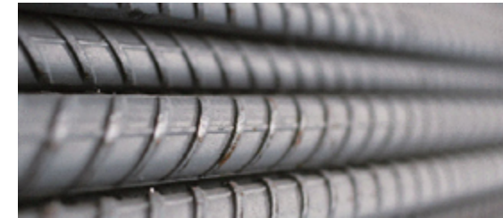
fig.9.41 BARRE D'ARMATURA AD ADERENZA MIGLIORATA Maggior rapporto di contatto efficace con il calcestruzzo
