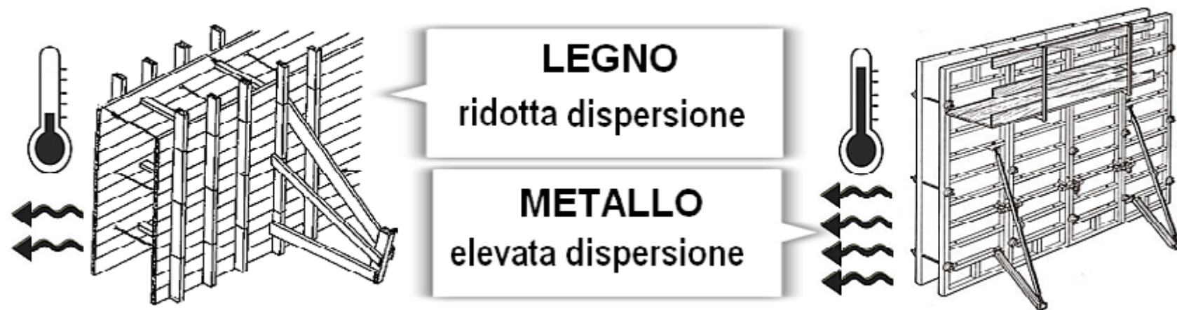
fig.9.72 DIVERSO MATERIALE PER LA CASSERATURA Differente conducibilità termica ( \lambda = W/mK ) dei casseri
