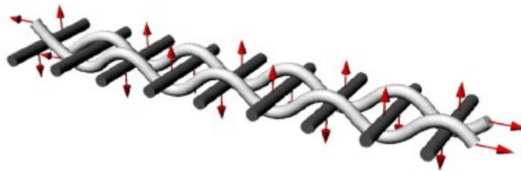
Figura 7.3: Effetti del tensionamento dell'ordito sulla trama
