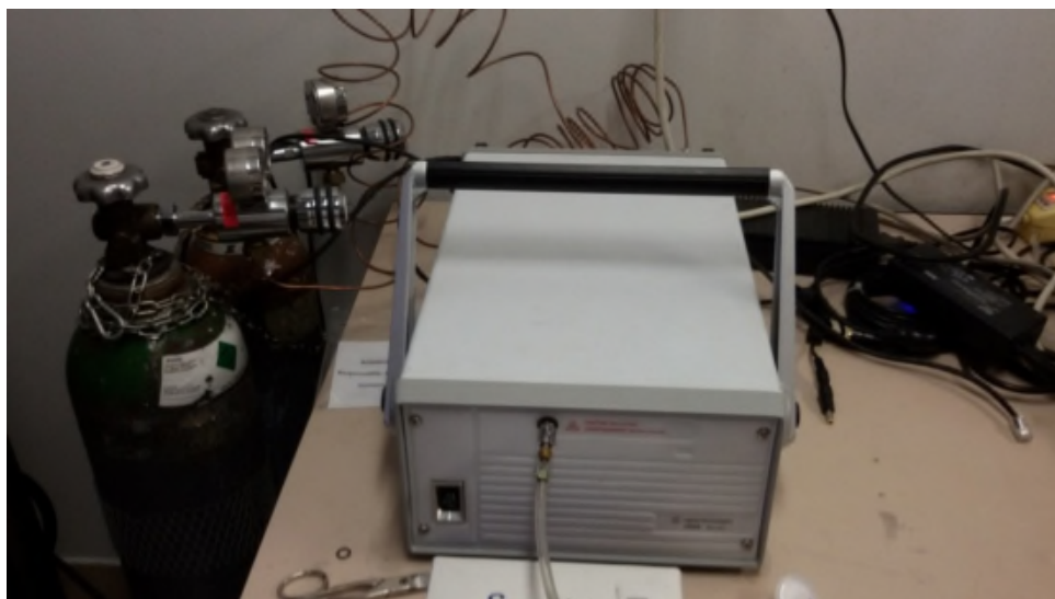
Figura 4.6 – Gascromatografo MICROGC 3000A, utilizzato per l'analisi della composizione del biogas, a destra si possono notare le bombole contenenti i gas carrier (una contenente argon, l'altra elio).
