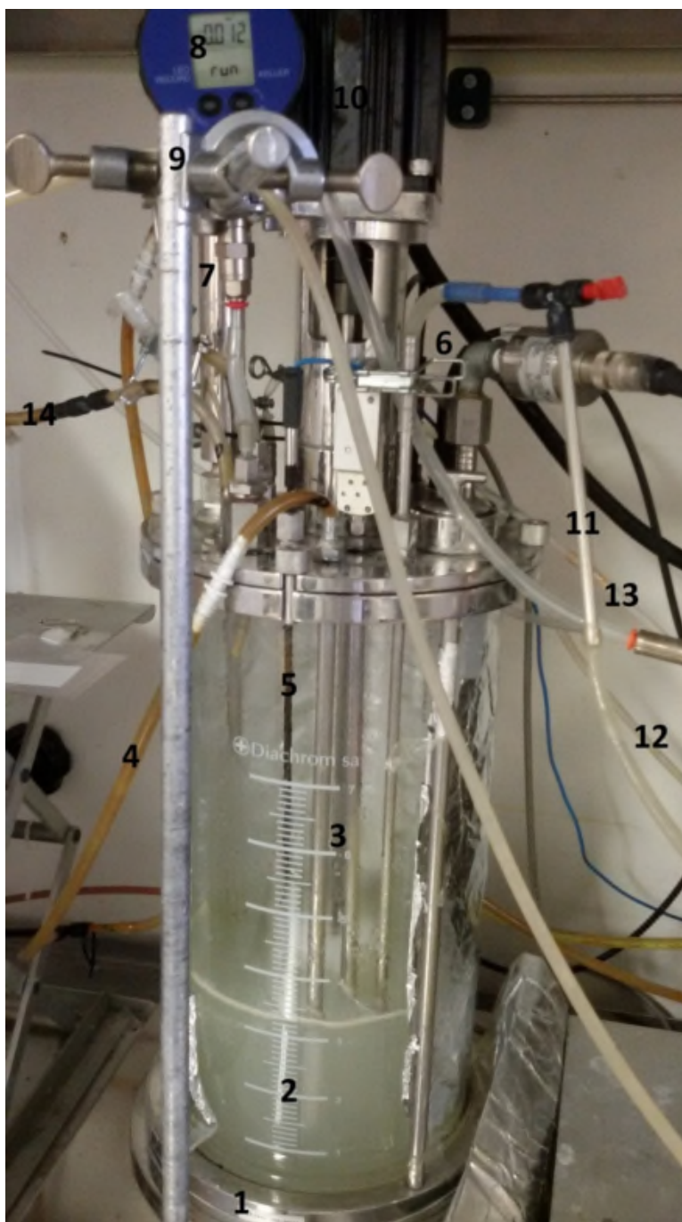
Figura 4.4 – Reattore CSTR, fornito dalla casa produttrice svizzera Diachrom.
