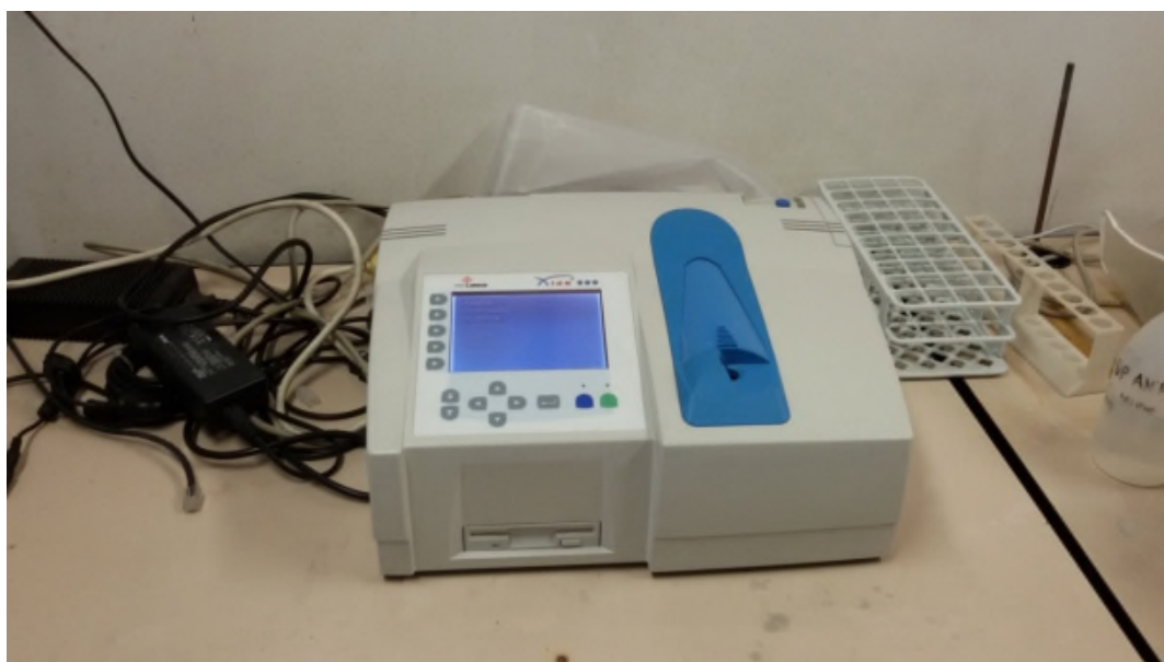
Figura 4.7 – Spettrofotometro di massa Lange Xion 500. Questo strumento permette di quantificare le analisi svolte attraverso l'utilizzo degli appositi kit.
