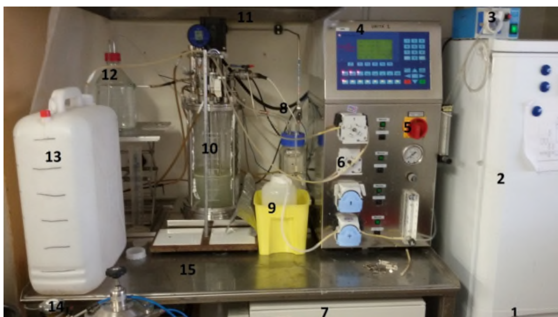
Figura 4.1 – Impianto pilota utilizzato per eseguire il processo di dark fermentation.
