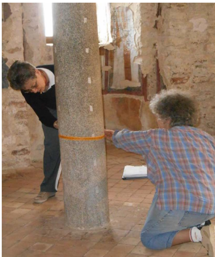
Figura 60 Misura della circonferenza della colonna a passi regolari di 20 cm
