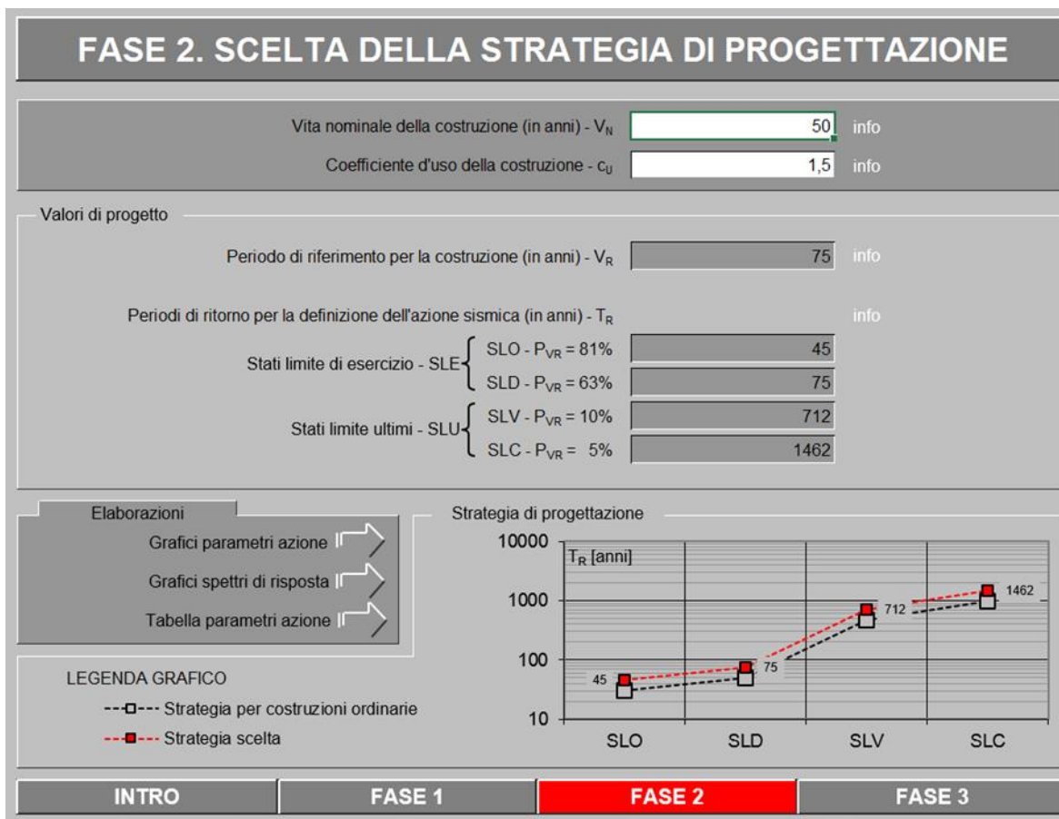
Figura 97-Scelta della strategia di progettazione, mediante foglio di calcolo
