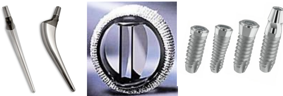
Figura 3.6 Esempi applicativi del titanio e delle sue leghe in ambito biomedico: stelo femorale (a sinistra), impianti dentali (al centro) e valvola cardiaca (a destra).
