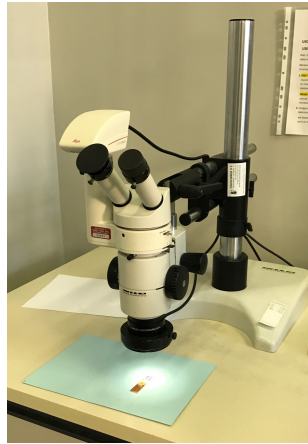
Figura 6.4 Immagine dello stereomicroscopio utilizzato in questo lavoro di tesi.
