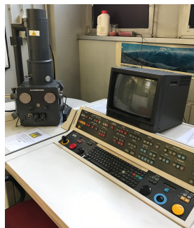
Figura 6.5 Immagine del SEM utilizzato in questo lavoro di tesi.
