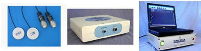
Figura 11: Strumentazione del dispositivo Anzai AZ-733V: sensori ad alta e bassa sensibilità, sensor port, convertitore analogico-digitale e PC.
