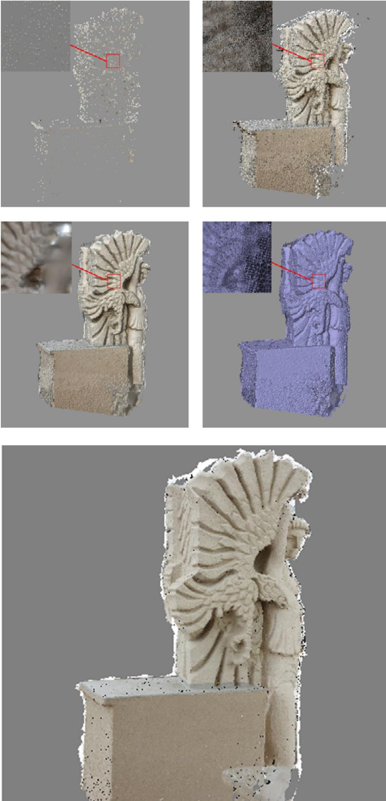
In alto sono illustrate le fasi di elaborazione delle fotografie. A sinistra si trova la nuvola di punti sparsa, accanto la nuvola di punti densa, sotto la mesh in vista ombreggiata, la mesh vista in wireframe e infine, sotto, l'ultimo passaggio con la texturizzazione. Le estrapolazioni sono state prese dal programma *Photoscan*.
