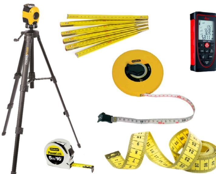
Alcuni strumenti del rilievo diretto, in particolare, da sinistra, la livella laser, montata su un cavalletto, il metro rigido e semirigido metallico, la bindella, il distanziometro laser e il metro da sarta.
