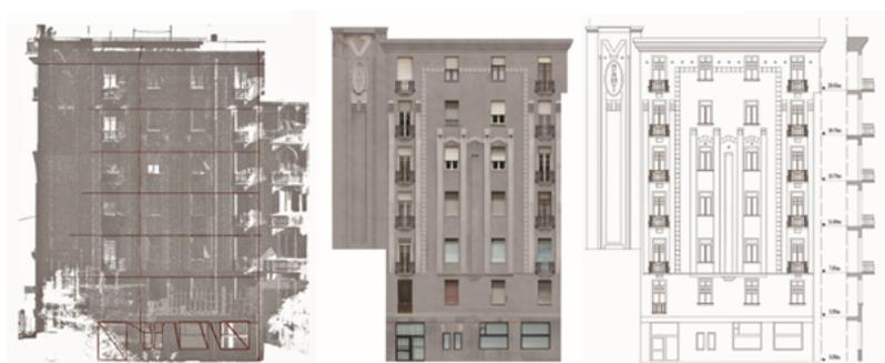
In alto è rappresentata la nuvola prodotta dalla scansione laser della facciata posteriore del Grattacielo, alla quale è stata sovrapposta la serie di punti rilevati utilizzando il disto laser 3D, evidenziata in rosso, con lo scopo di verificare l'attendibilità delle misurazioni. Infatti i due metodi di rilievo risultano combacianti.
