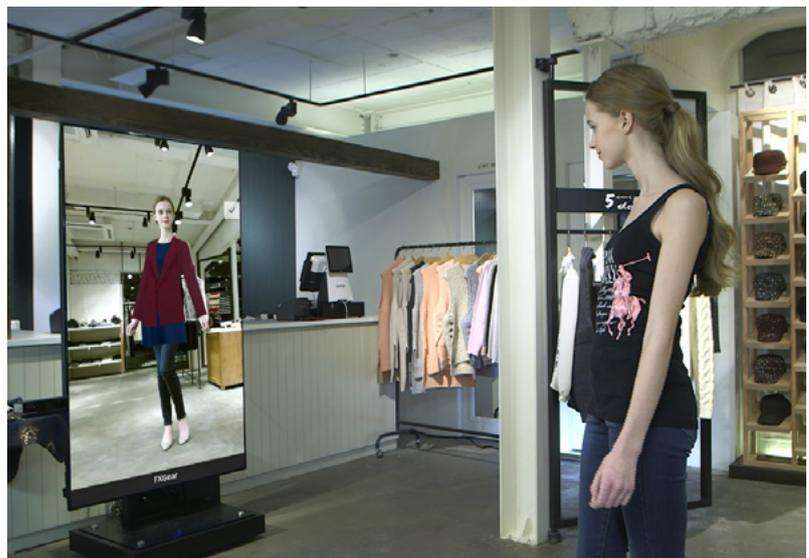
Il “camerino virtuale” permette ai clienti di specchiarsi indossando digitalmente l'abito desiderato. Il software di visualizzazione, posizionato dietro lo specchio, sfrutta un sensore 3D per adattare automaticamente gli abiti virtuali alle misure del corpo.
