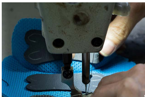
fig. 11.5 Applicazione di rinforzi
