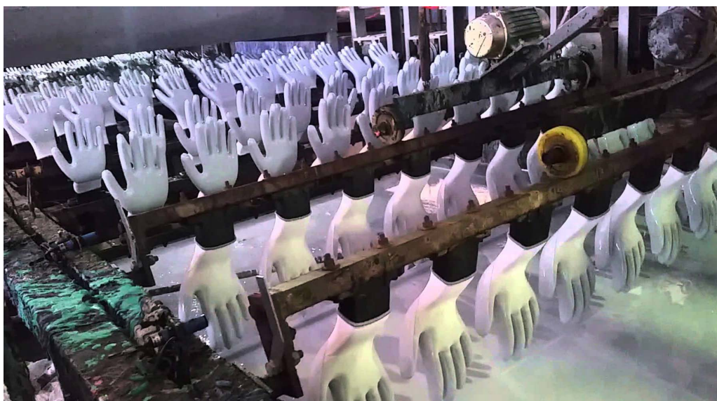
fig 12.46 Processo produttivo applicazione layer su guanti da lavoro
