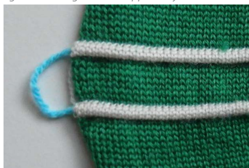
fig. 5.21 Dettaglio alloggiamento stringa by Stoll
