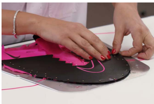
fig. 11.18 Applicazione dello strato di pelle su tomaia
