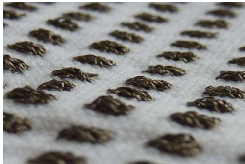
fig. 5.28 Filo conduttivo, dettaglio
