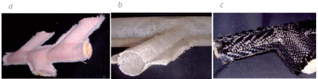
fig. 2.13 Strutture nodali di varie fibre. (a) Poliestre. (b) Fibra di vetro. (c) Fibra di carbonio
