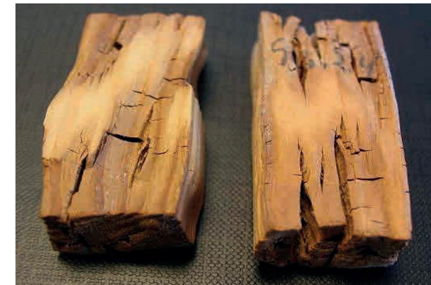
Figura 101_Variazioni dimensionali del legno dovute all'umidità
