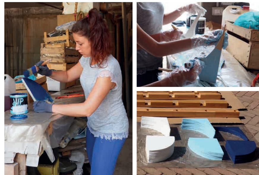
Figura 253_Tinteggiatura dei pannelli OSB
