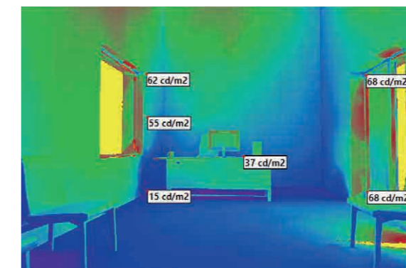
Figura 300_Vetro triplo prestazionale con Krypton - T_l=47\%
