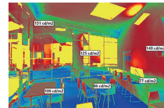
Figura 320_Vetro triplo prestazionale con Krypton - T_l=47\%
