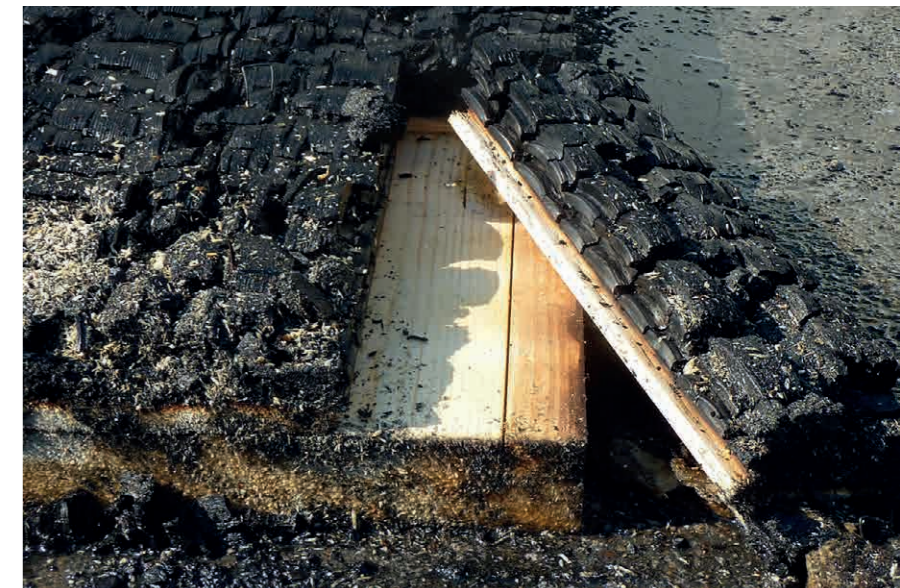
Figura 106_Sezione del legno interna non bruciata
