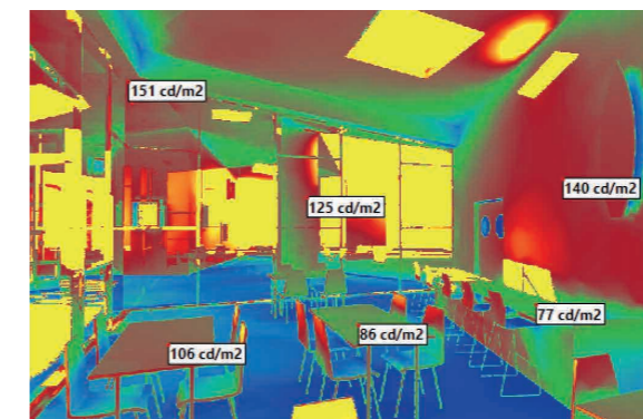
Figura 48_Vetro triplo prestazionale con Krypton - T_l=47\%
