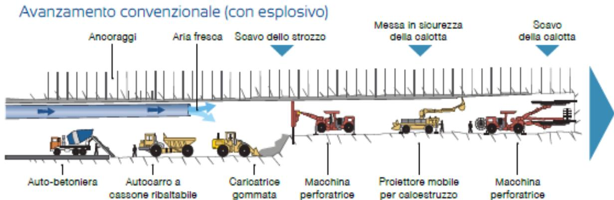
Figura 22 Schema fasi scavo in tradizionale
