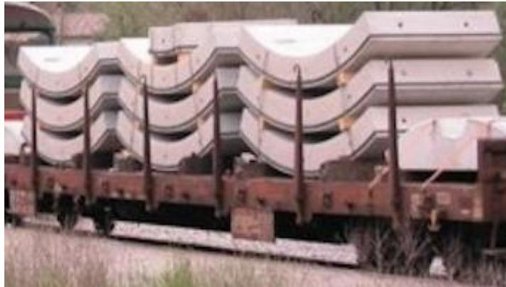
**Figura 146 Trasporto Mediante Carro Ferroviario Pianale**
