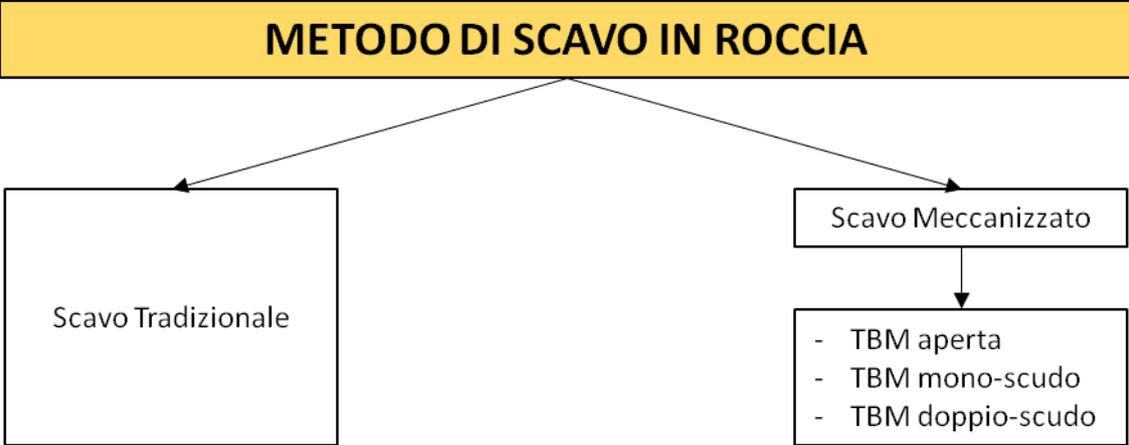
Figura 21Flow – Chart Metodi di Scavo in Roccia
