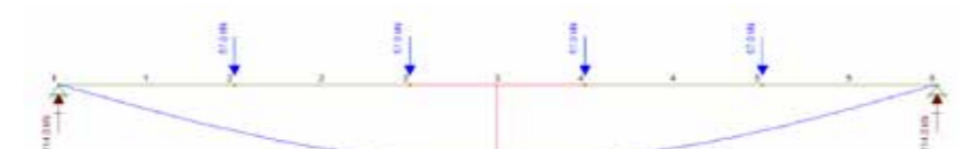
Fig. 4.18 Deformata trave principale della copertura appoggio appoggio SLU
