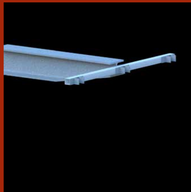
Fig. 5.19 Fase montaggio 3 Saldatura delle piastre di ancoraggio per i montanti verticali 1 ogni metro
