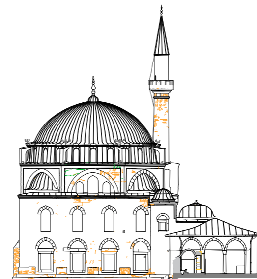
Fig. 7.28quadro fessurativo prospetto Nord-Est.pdf
