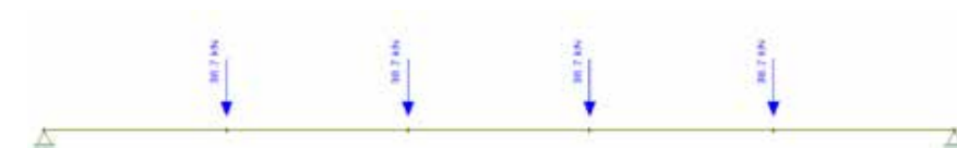
Fig. 4.14 Schema statico trave principale copertura SLE
