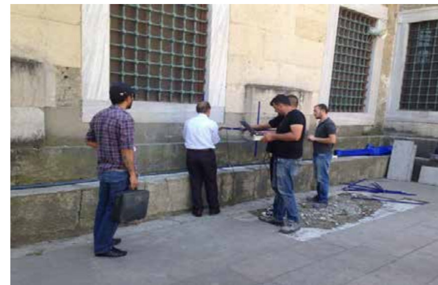
Fig. 7.65 Rilievo fotografico campagna diagnostica GRD
