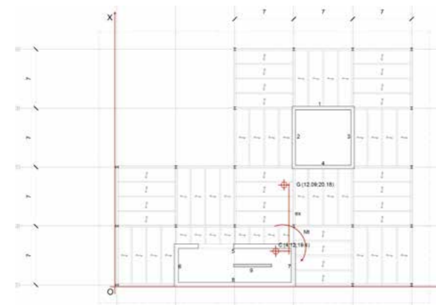
Fig. 4.37 Schema del momento torcente applicato
