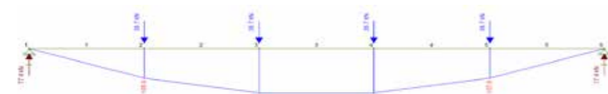
Fig. 4.16 Diagramma dei momenti trave principale appoggio-appoggio copertura SLE
