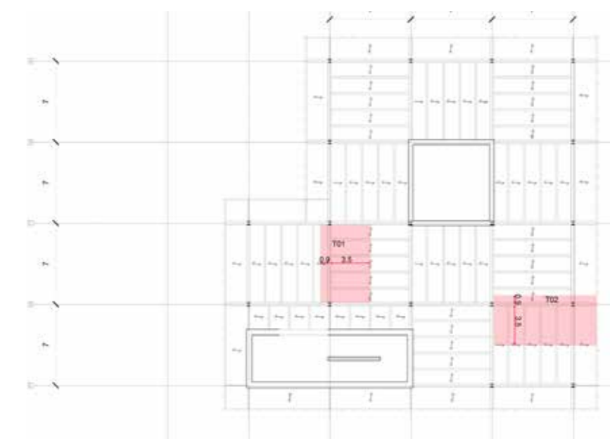
Fig. 4.13 Schema strutturale pianta della copertura
