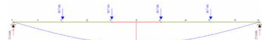
Fig. 4.15 Deformata trave appoggio appoggio copertura SLE
