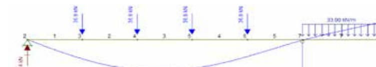
Fig. 4.20 Schema statico trave appoggio-appoggio-estremo libero SLE
