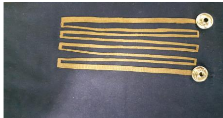
Fig. 3.8: a. dimensioni fascia estensimetrica CAD; b. fascia estensimetrica implementata e posizionata sulla maglietta.
