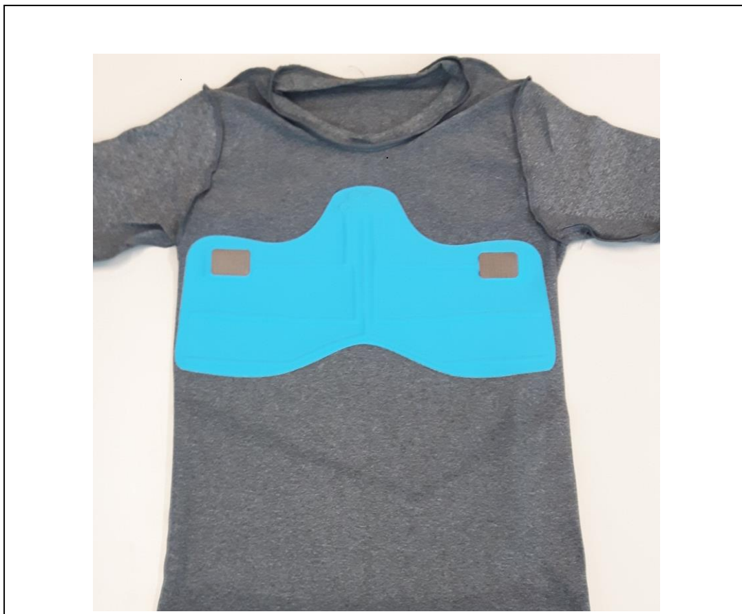
Fig. 3.5: Secondo prototipo, maglietta grigia, con elettrodi per ECG, e due sensori di pressione, vista interna.
