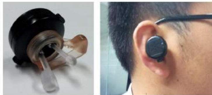
Fig.2.2: Sistema ad auricolare per il monitoraggio della frequenza cardiaca del primo prototipo di auricolari.
