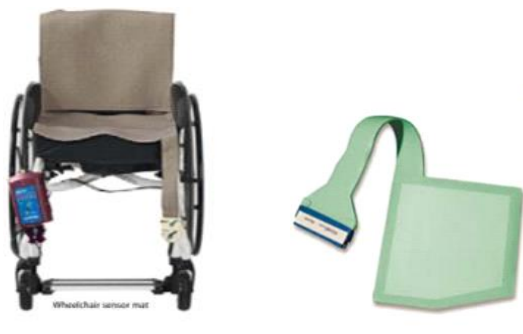
Fig.2.23: Sedia a rotelle dove viene posto il tappetino in verde che è costituito da trasduttori capacitivi per monitorare le diverse aree di pressione generate dai pazienti sulla sedia.
