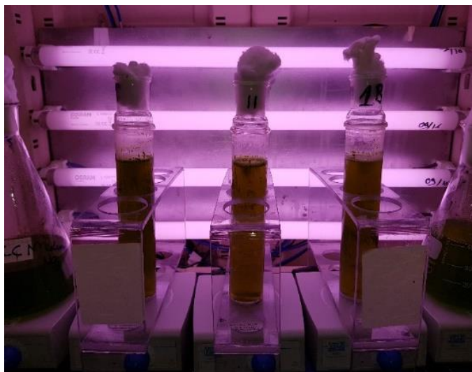
Figura 3.2.2: Reattori a colonna di crescita utilizzati per le prove su WW1.
