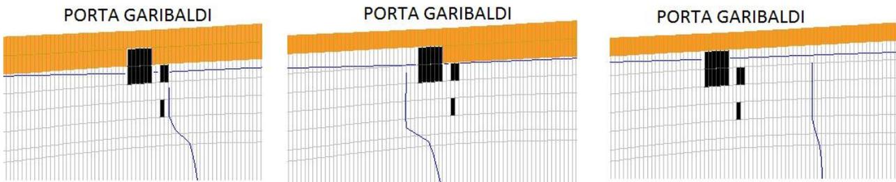
Figura 77 - Variazione del livello piezometrico e delle dry cells (in arancio) presso Porta Garibaldi: situazione attuale (sx) e al variare degli scenari di prelievi idrici diminuiti del 20% (centro) e del 50% (dx)
