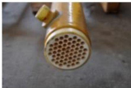
Figura 13: Sezione trasversale della membrana di ultrafiltrazione installata nel comparto esterno del digestore anaerobico.
