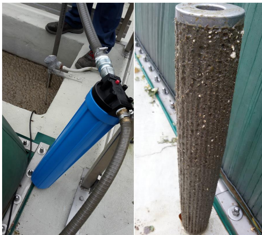
Figura 20: Fase di prelievo del digestato PLAC tramite pompa ad immersione e passaggio nel filtro a 250 \mu\text{m} (involucro blu). A destra la membrana intasata a causa del materiale grossolano contenuto nel digestato.
