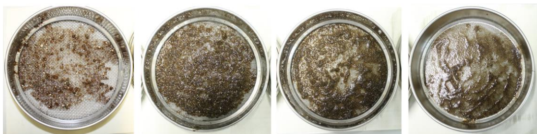
Figura 23: Residui solidi della filtrazione del fango di PLAC con setacci in serie. A partire da sinistra: 2000 \mu\text{m} , 1000 \mu\text{m} , 500 \mu\text{m} , 250 \mu\text{m} .
