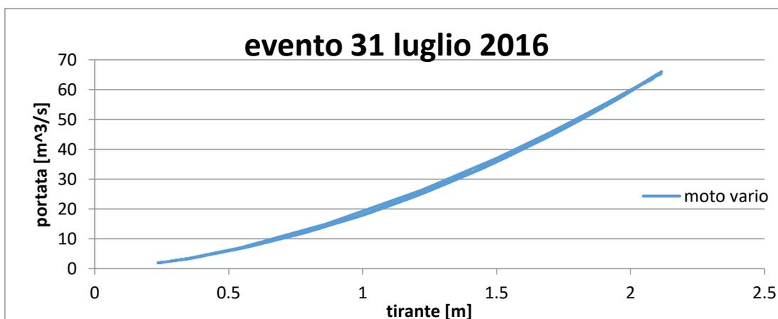
Figura 4.6: Simulazione in moto vario tramite Hec-Ras per l'evento del 31 luglio 2016 nella sezione di riferimento.
