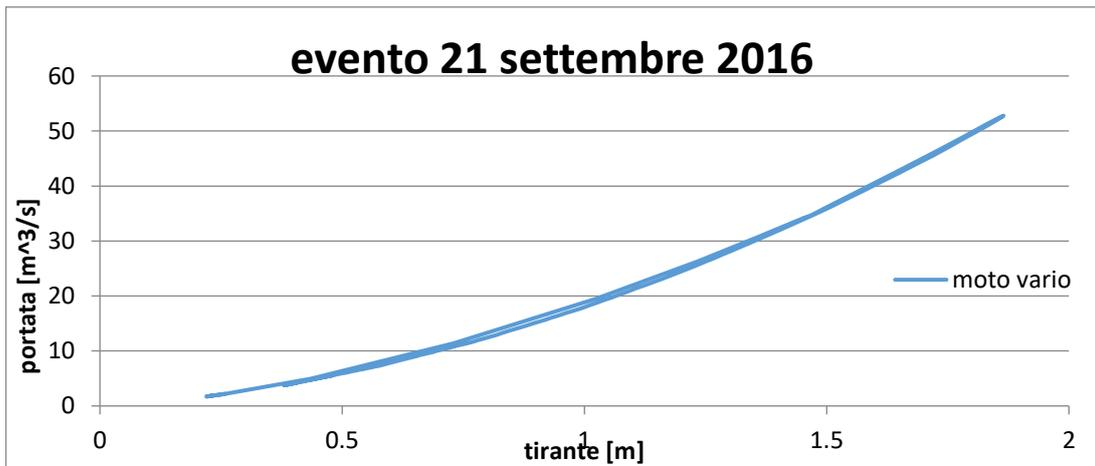
Figura 4.7: Simulazione in moto vario tramite Hec-Ras per l'evento del 21 settembre 2016 nella sezione di riferimento.
