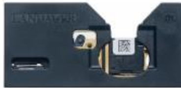
Figura 3.12. Adattatore per nanoDot.
