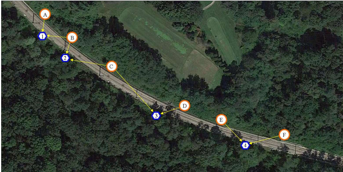
Figura 1.3-A Schema rilevamento. Lettere=punti di misura; Numeri=punti di riflessione
