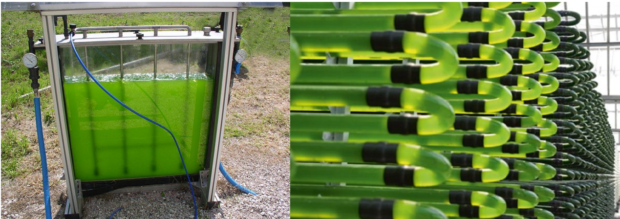
Figura 2.6 Esempi di fotobioreattore, a sinistra un PBR a lastra piana ( https://scubla.it ), a destra un reattore tubolare (Torzillo e Chini, 2015)
