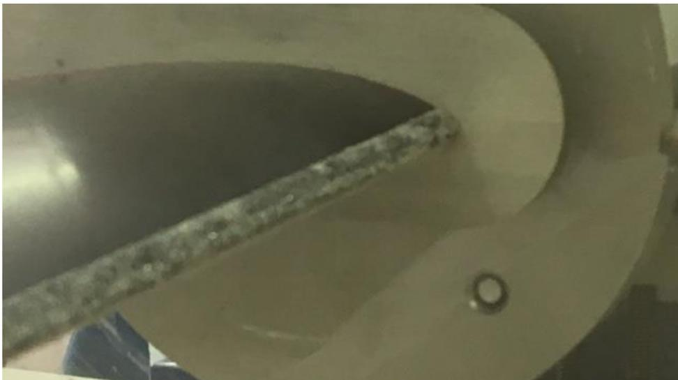
Figura 6.4.1 Applicazione di una striscia abrasiva sul bordo d'attacco del NACA4412
