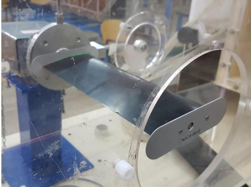
*Figura 2.1 Modello NACA 0015 utilizzato con in primo piano la paratia destra montata nelle prove*
