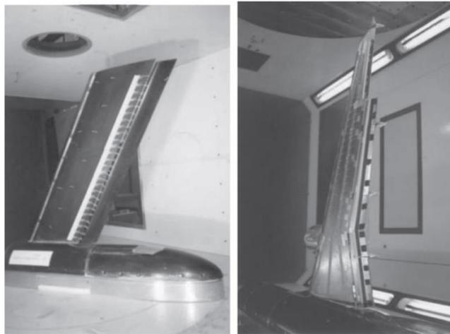
*Figura 1.2.6 Ala a freccia a corda costante (a sinistra) e ala a freccia rastremata(a destra) derivata dall'ala di Airbus A320*
