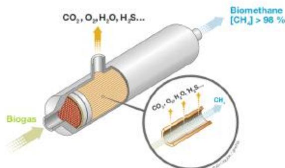
Figura 11. Esempio di flussi entranti e uscenti da una membrana per l'upgrading del biogas (13)
