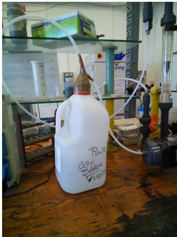
Figura 40: Il sistema di umidificazione realizzato
