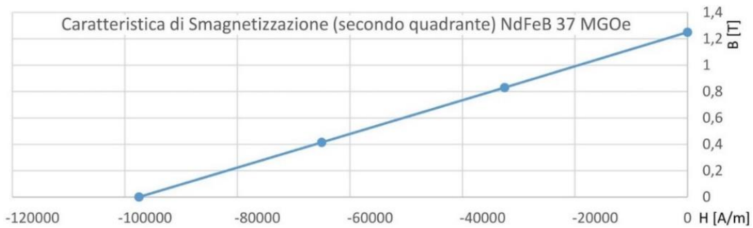
Fig.2.6c Caratteristica di smagnetizzazione (II quad.) – NdFeB 37 MGOe
