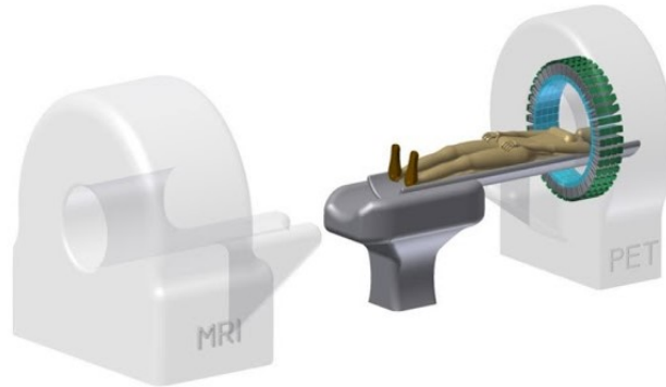
Figura 1.1 Rappresentazione schematica dell'approccio sequenziale sviluppato per combinare medicina nucleare e scanner radiologici (in questo esempio una PET/MR).
