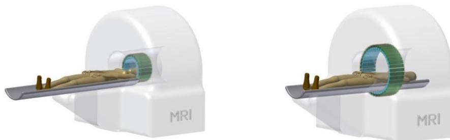
Figura 1.2 Vista schematica di un sistema multimodale integrato ottenuto combinando scanner di medicina e radiologia uno dentro l'altro. A sinistra, una PET/MR per acquisizioni collo/testa. A destra uno scanner PET/MR per corpo intero.
