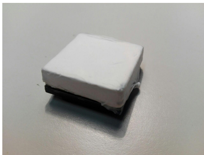
Figura 3.12 Medesimo tile di SiPM utilizzato per calcolare i fattori correttivi con il cristallo questa volta coprente l'intera superficie e non il singolo pixel, per valutare come cambia la risoluzione energetica.
