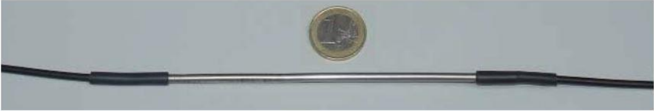
Figura 2.2: Configurazione commerciale di un FBG (posto a metà della lunghezza del tubo rigido) per le misure di temperatura.
