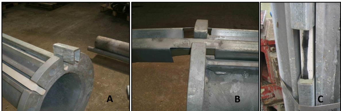
Figura 3.6: Foto della modifica al tubo su cui è installato BLESS, A) canalina, B) Flangiatura e C) Foro contenente il generico FBG.
