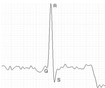
Figura 2.4: Battito anomalo causato da un movimento dell'utente durante l'acquisizione con il dispositivo indossabile Bio2Bit. Il rumore generato dal movimento si somma al segnale causando la scomparsa delle onde P e T e alterando così la corretta morfologia del battito.
