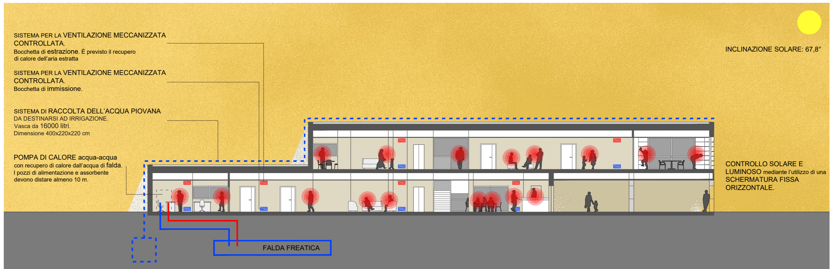
Fig. 100 Schematic design: situazione invernale Fig. 101 Schematic design: situazione estiva
