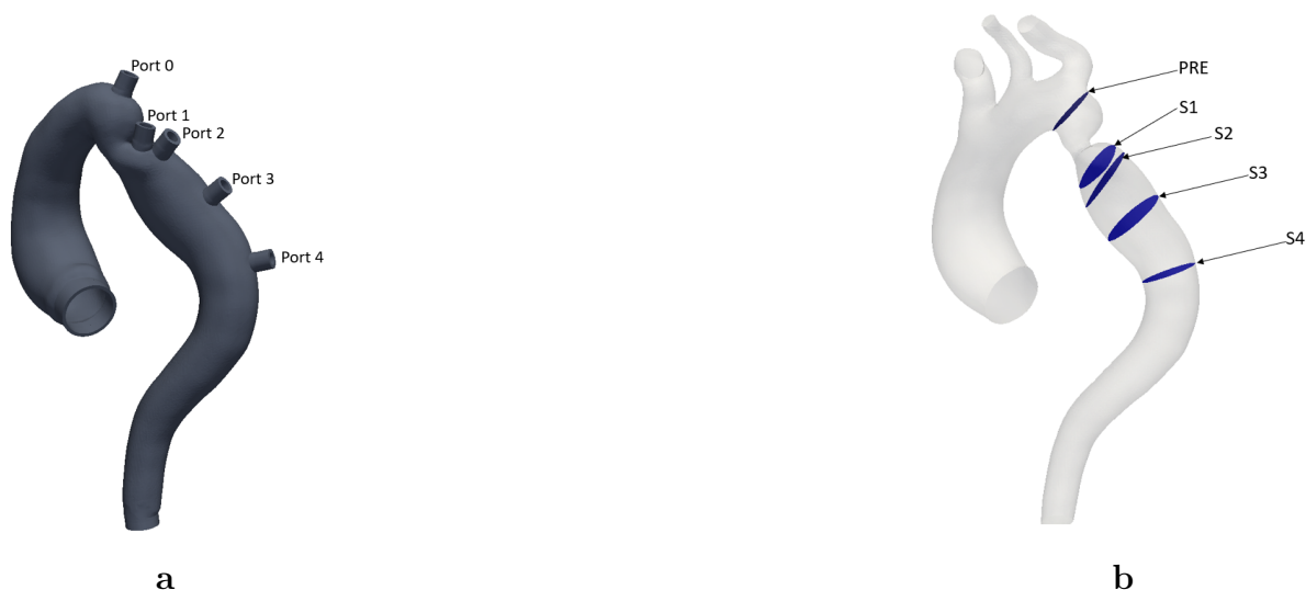
Figura 16: Modello 3D usato per la piattaforma in vitro con le porte create per i trasduttori di pressione (a) e le corrispondenti sezioni nel dominio computazionale(b) (denominate S1-S4).
