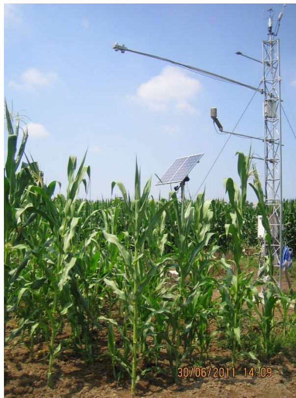
Figura 2.2-1 Immagine della stazione eddy covariance in sito che fornisce i dati utilizzati nel corso di questo lavoro di tesi.
