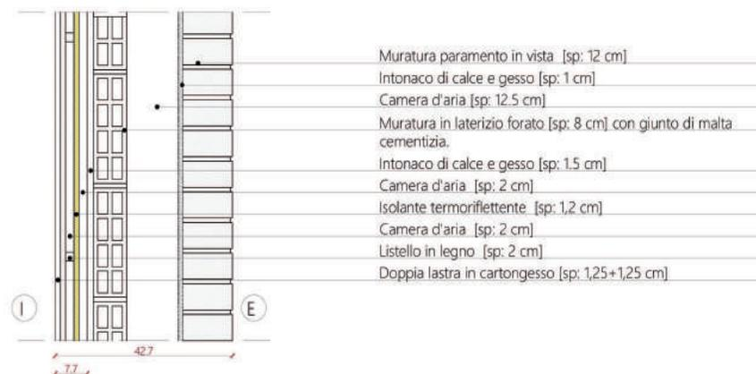
La trasmittanza stazionaria della struttura così come riportata sopra è pari a 0,212 W/m<sup>2</sup>K.
