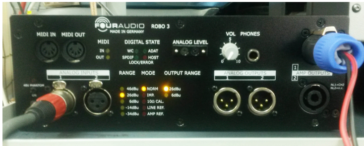
Figura 5.6. Schema di collegamento della scheda audio al PC e al compression driver (a), scheda audio e frontend di misura ROBO3 della Four Audio (b)
