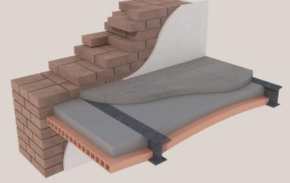
La muratura degli edifici non destinati a residenza, quindi stalle e pollai, è realizzata con mattoni disposti a tre teste, esternamente intonacati. I solai, invece, sono composti da una struttura a travi metalliche e voltri in cotto, mentre il piano di calpestio è in cemento gettato in opera.
