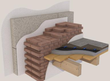
La muratura in mattoni viene mantenuta e su di essa viene posato il capotto esterno in fibra di legno, a sua volta intonacato e tinteggiato. Il solaio è completamente rifatto: su un'orditura lignea vengono posizionati in ordine un assito, un massetto inerte, un tappetino acustico, i pannelli radianti e infine la pavimentazione in gres porcellanato.
