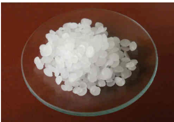
Foto 2.13 Isolante PCM - Microcapsule di Paraffina.
