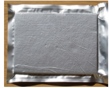
Foto 2.2 VIP - esempio di pannello isolante sottovuoto, prodotto della Ditta Variotec.
