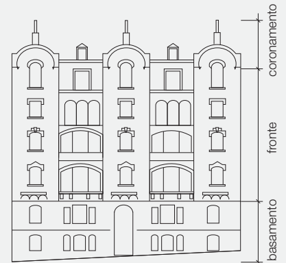
Fig. 140_Schema tipo di una facciata gaiolera: divisione in tre ordini e presenza di loggiati
